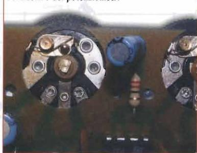
nelle radioline miniatura a pila. Questi potenziometri vanno montati lato saldature e sono già dotati di interruttore di alimentazione. Due LED indicheranno che le due sezioni sono in efficienza ed accese. Una raccomandazione: non estrarre o infilare i jack con apparecchio acceso. Il passaggio dei contatti potrebbe, ad apparato acceso, danneggiare i circuiti o i trasduttori. Dopo aver montato tutto potrete
